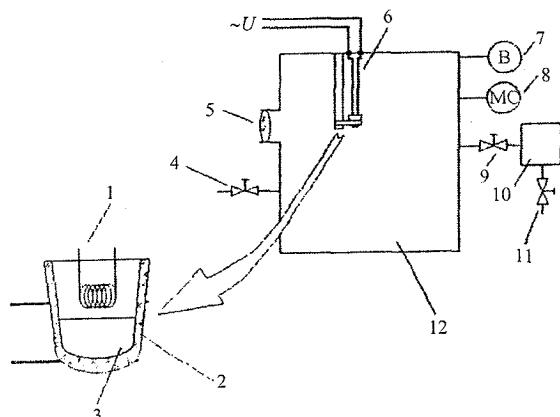
Рис. 7. Схема экспериментальной установки для исследования состава газа:
