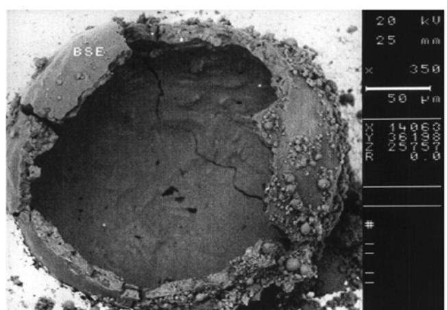
Рис. 4. Электронно-микроскопическая фотография отдельно взятой сферической частицы (проба № 597 в режиме обратнорассеянных электронов; увеличение x350)
